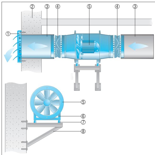
För fast installation i rörledningar med spirorör som passar till utrustningstypen (nominell diameter). Montering på vägg, tak eller konsol med tillräcklig bärighet.
